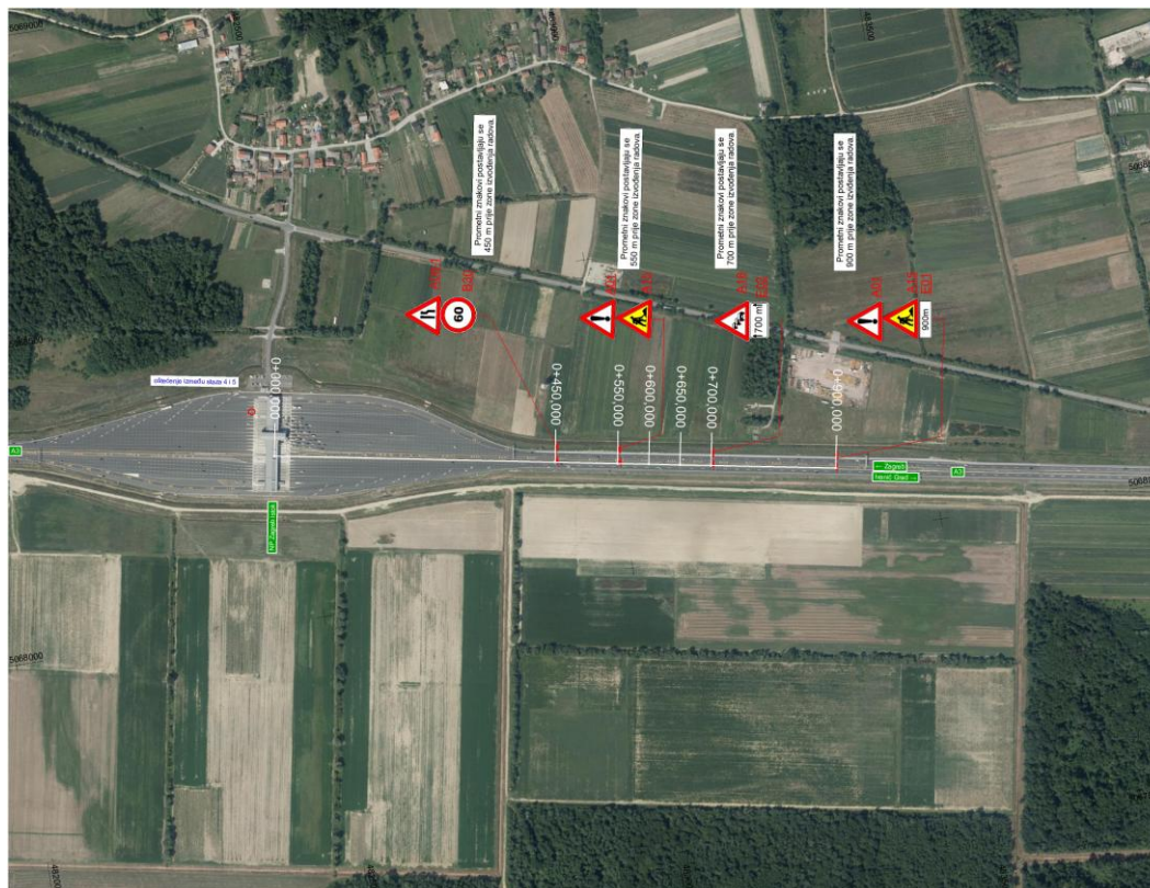
Slika 1. Privremena regulacije prometa za vrijeme izvođenja radova
