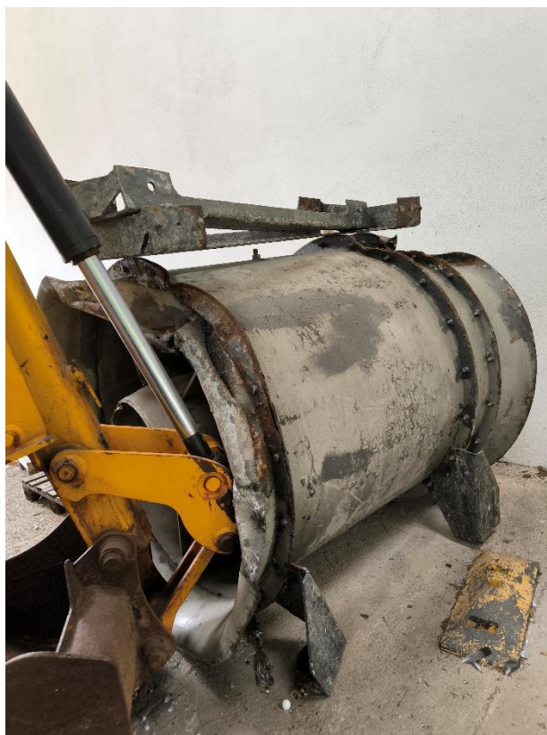
Slika 2. Oštećeni ventilator kojeg je potrebno zamijeniti – bočna strana
