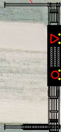
DISPLAY 2 - Display prema Macelju (novi displej se montira na novi portal)
