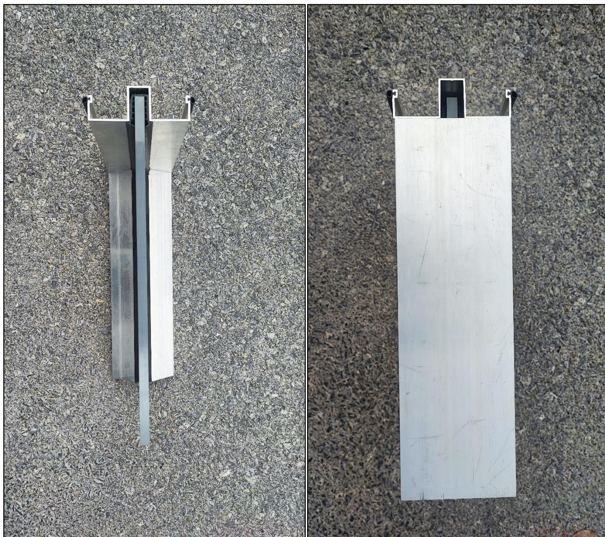
Slika 7. Transparentni panel (prednja i stražnja strana) s brtvenom gumom
