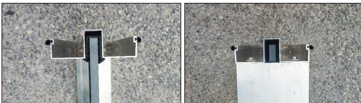
Slika 8. Presjek transparentnog panela (prednja i stražnja strana) s brtvenom gumom
